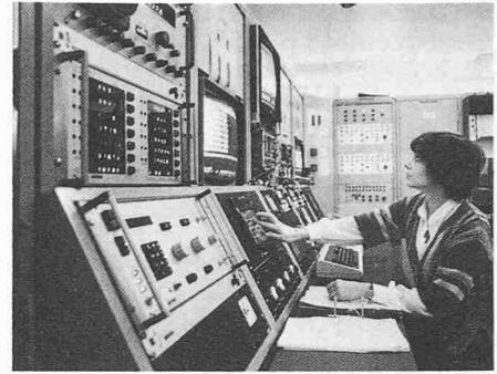
Ein speziell ausgerüsteter Kleincomputer im Steuerpult der Tandem-Nachbeschleuniger-Kombination ermittelt innerhalb weniger Sekunden ungefähr 90 Werte für die optimale Beschleunigung verschiedener Ionensorten
