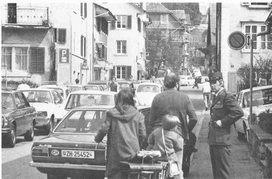
Bild 2. Eine «fast einspurige Strasse». Die Fahrbahnbreite beträgt 6 m. Neben der Längsparkierung verbleibt eine knapp 4 m breite Fahrspur, welche die Autos zum Kreuzen verleitet. Damit sind Fussgänger und Velofahrer gefährdet
