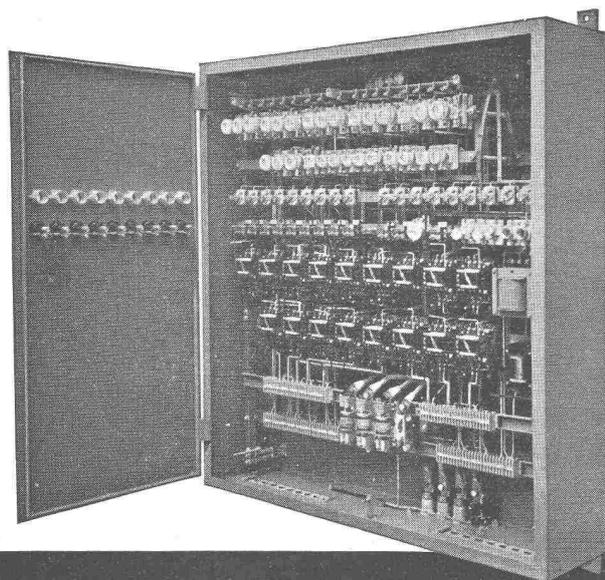
Unsere Verteilkasten und -schränke werden für Aufbau- oder Unterputzmontage, auch staub- und spritzwasserdicht, in jeder beliebigen Ausführung und Grösse geliefert. Die Innenausrüstung ist praktisch, mit genügend Montage-raum, das Aeussere von zweckmässiger Schönheit. Die Apparate werden fertig eingebaut und verdrahtet; der Apparaterost lässt sich zur Montage einfach herausheben. Gute Erweiterungsmöglichkeit. Verlangen Sie bitte unsere Prospekte.
