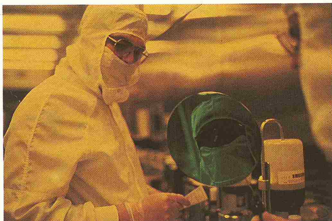
Bild 4. Anlage zur Beschichtung von Siliziumscheiben mit lichtempfindlichem Photolack, aus Vorratsflaschen mit Partikelfiltern dosiert. Durch anschliessendes Abschleudern bei mehreren tausend Umdrehungen pro Minute wird eine von Lackviskosität und Drehzahl abhängige Lackdicke erreicht. Das folgende Backen der Scheiben auf Heizplatten entfernt überschüssiges Lösungsmittel aus dem Lack und stabilisiert dadurch den sich anschliessenden Photolithographieprozess
