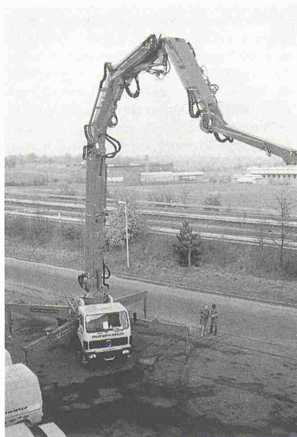
Der enorm bewegliche, 5fach geknickte HfH-Arbeitsmast bringt Lasten bis 1,5 t und einer Reichhöhe von 26 m schnell und punktgenau in Position
