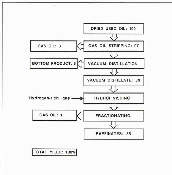
Bild 6. KTI Hydrofinishing Process
