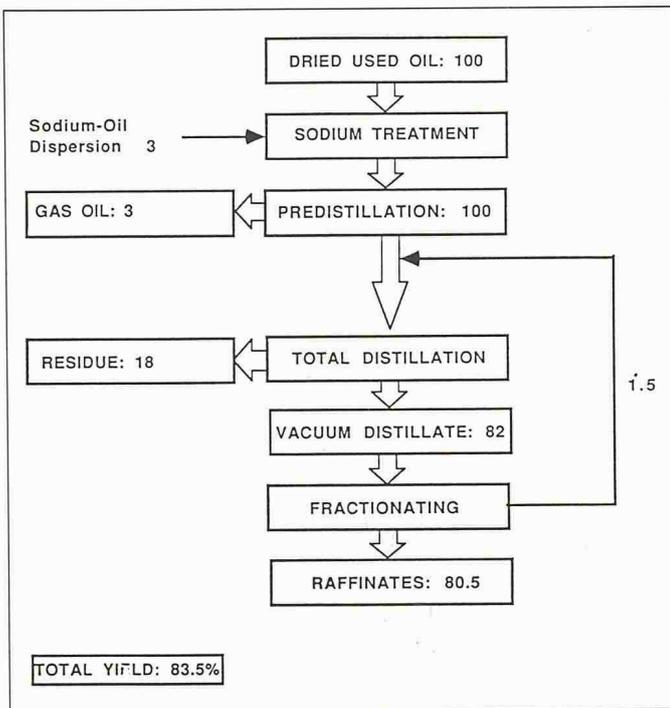
Bild 4. Recyclon Process
