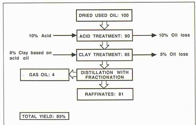
Bild 3. Modified Acid Clay Process
