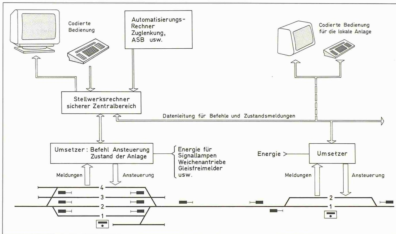
Bild 1. Elektronisches Stellwerk 2000
