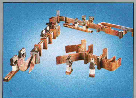
KERNENERGIE Einspeisung einer Induktionsspule, aus Massivkupfer gefertigt und mit Band isoliert.
