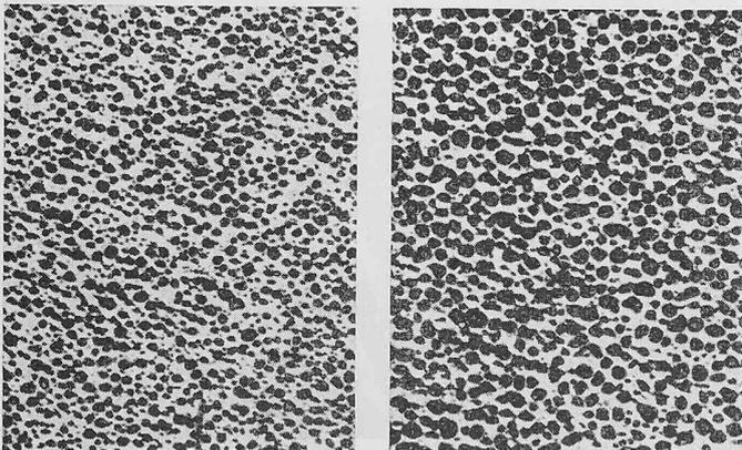
Bild 5. Struktur des Siporex in natürlicher Grösse. Links Raumgewicht 0,6, rechts 0,4 kg/dm<sup>3</sup>.
