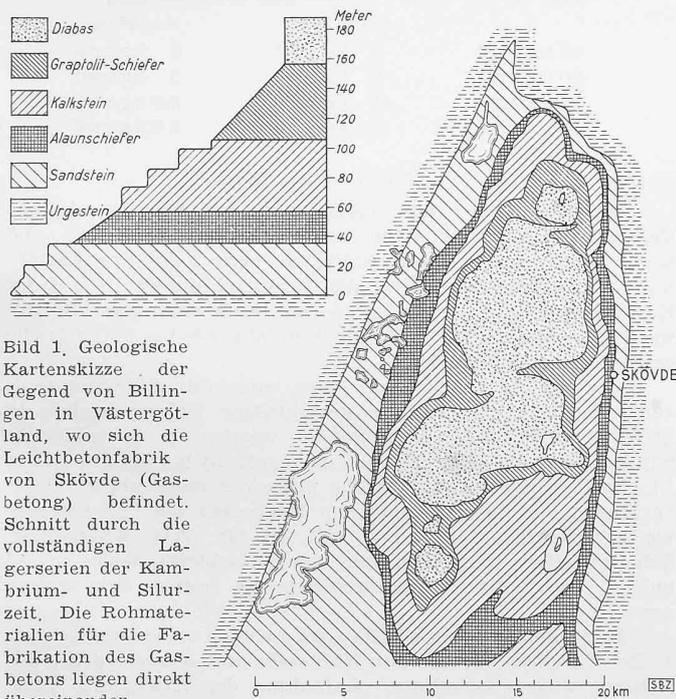
Bild 1. Geologische Kartenskizze der Gegend von Billingen in Västergötland, wo sich die Leichtbetonfabrik von Skövde (Gasbeton) befindet. Schnitt durch die vollständigen Lagererien der Kambrium- und Silurzeit. Die Rohmaterialien für die Fabrikation des Gasbetons liegen direkt übereinander.
