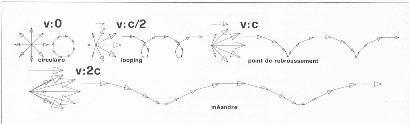
Fig. 3. — Différents modèles de courants obtenus par superposition d'un mouvement d'inertie et de mouvements uni-directionnels. En haut à gauche est représenté le vecteur rotatif à vitesse constante  $c$ . Les superpositions de ce courant rotatif avec différents courants unidirectionnels à vitesse variable,  $v$ , sont dessinées soit à l'aide de vecteurs de même origine soit à l'aide d'hodographes intégrés (d'après fig. 78 de Mortimer) [13].
