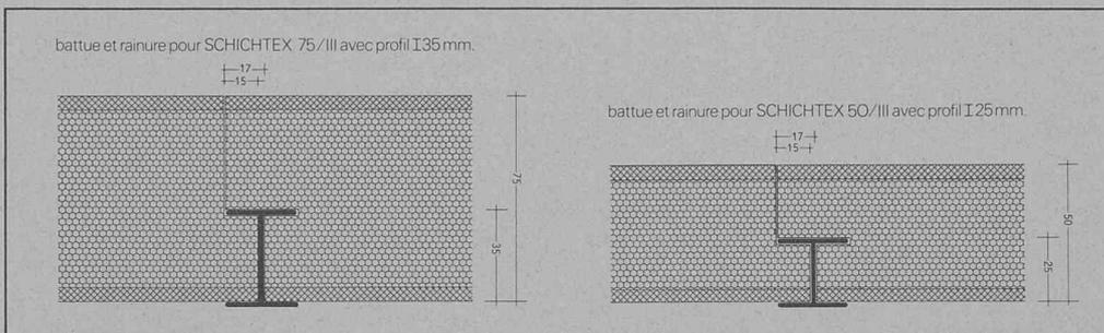
une plaque en stratifié également comte revêtement inférieur. L'âme est en polystyrène. Les panneaux comportent une battue sur tout le pourtour et un double recouvrement de 6 cm de haut et sur les côtés. Ils sont livrables en épaisseurs de 80, 105 et 125 mm. Une nouveauté: les panneaux stratifiés apparents avec revêtement pelliculaire sur la face visible.
