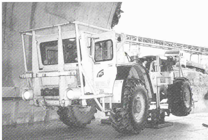
VibroScan-Schwingungsgenerator zur Simulation von Verkehrserschütterungen
