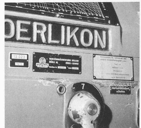
Bild 10. Objekt-Nummer-Schild und Schmieranleitung
