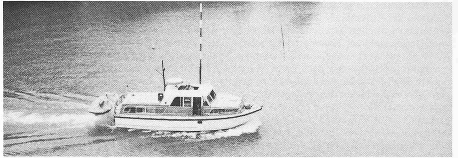
Das Vermessungsschiff «Explorer» des Vermessungsbüros Dr. Schlund auf dem Walensee. Die Wassertiefe wird mit einem Ultraschall-Echolot kontinuierlich gemessen und aufgezeichnet. Die Positionsbestimmung des Schiffes erfolgt mit Hilfe von Laserstrahlen ebenfalls kontinuierlich von einer Landstation aus; alle Messwerte werden im Bordcomputer verarbeitet
