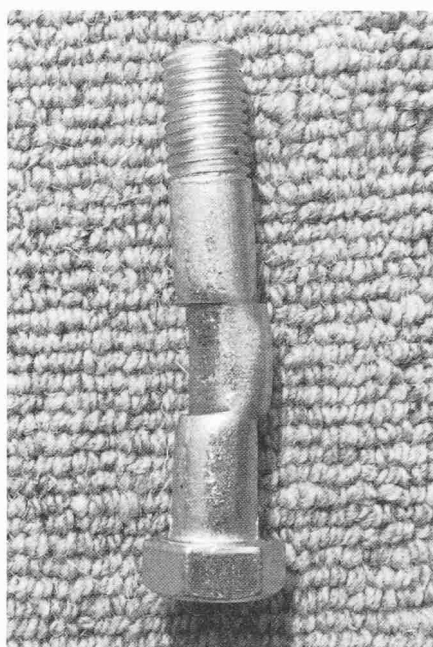
Bild 8. 3. Versuch, Nach starker Scher-Verformung hat die Schraube noch ihre volle Tragkraft
