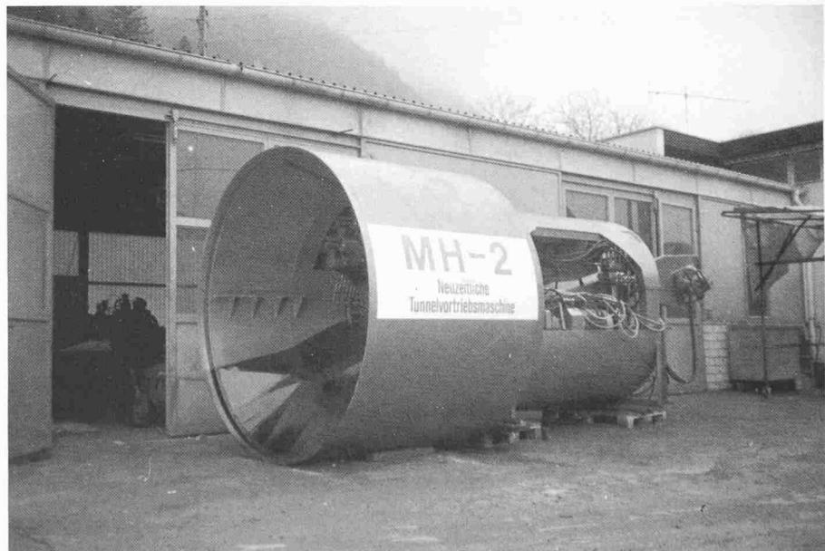
Nachlaufrohr (Power unit)
