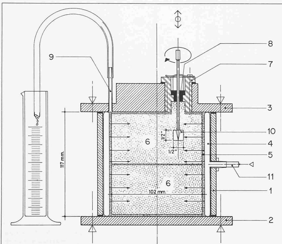
Fig. 3. Coupe schématique avec dispositif pour consolidation sous double étreinte ( $\tau_2 = \tau_3, \epsilon_1 = 0$ )
