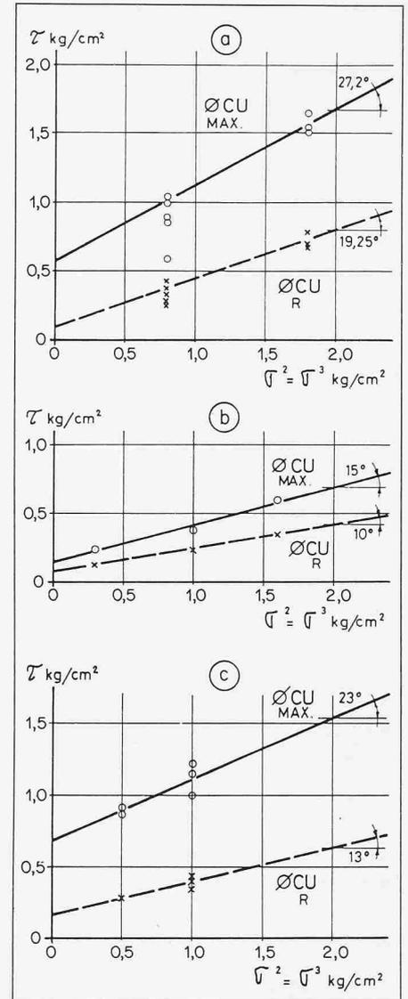
Fig. 6. Diagrammes de quelques sols. Résistance au cisaillement
