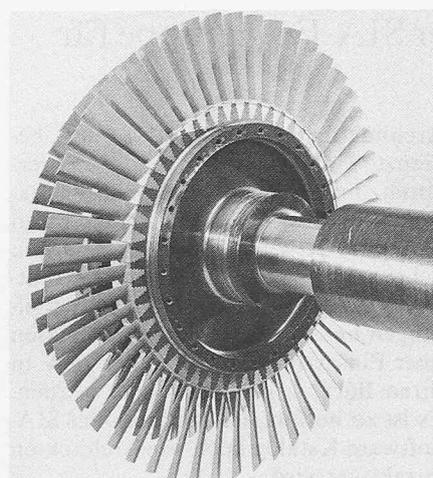
Rotor einer Heliumturbine (Drehzahl bis 300 000 U/min); links der Expanderotor, rechts der Bremskompressor
