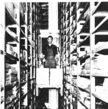
Fahrzeug-Ersatzteillager. Kommissionierung mit einem Regalförderzeug Decombi.
