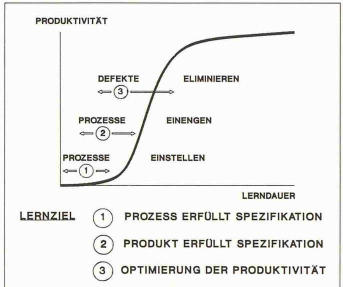
Bild 25. Produktivitäts-Lernkurve in der Halbleiterfertigung
