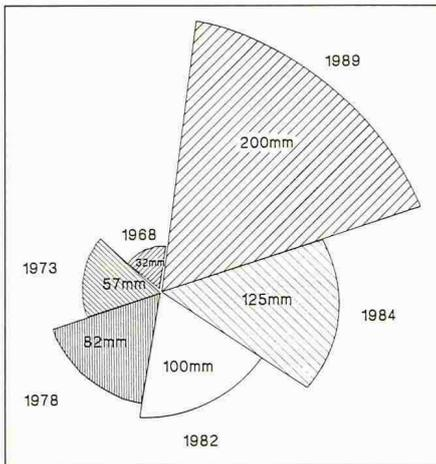
Bild 21. Entwicklung der Wafer-Größen (Siliziumscheiben) seit 1968
