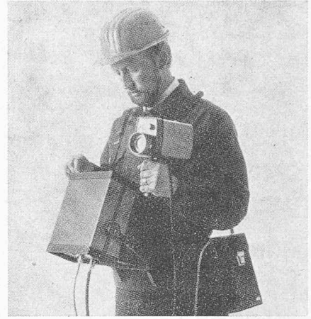
Bild 1 (links). Transformator mit fehlerhaftem Leitungsanschluss. Der Fehler ist an der übermässigen Erwärmung des Isolators zu erkennen (helle Bildstelle). – Bild 2 (Mitte). Emissionsvermögen eines schwarzen Körpers als Funktion der Wellenlänge bei verschiedenen Temperaturen (Plancksche Kurven). – Bild 3 (rechts). Tragbare Messausrüstung für thermographische Aufnahmen
