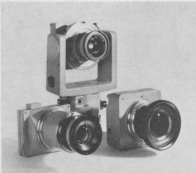
Emulsion, Kammerneigung bis zum Zenit sowie horizontale Schwenkung um  $360^\circ$  mit festen Rasten, Aufnahmen im Hoch- oder Querformat, Änderung der Fokussierdistanz durch austauschbare Zwischenringe ( $f = 10$  cm und  $f = 20$  cm), grosser Schärfentiefebereich bei der Überweitwinkelkammer.
