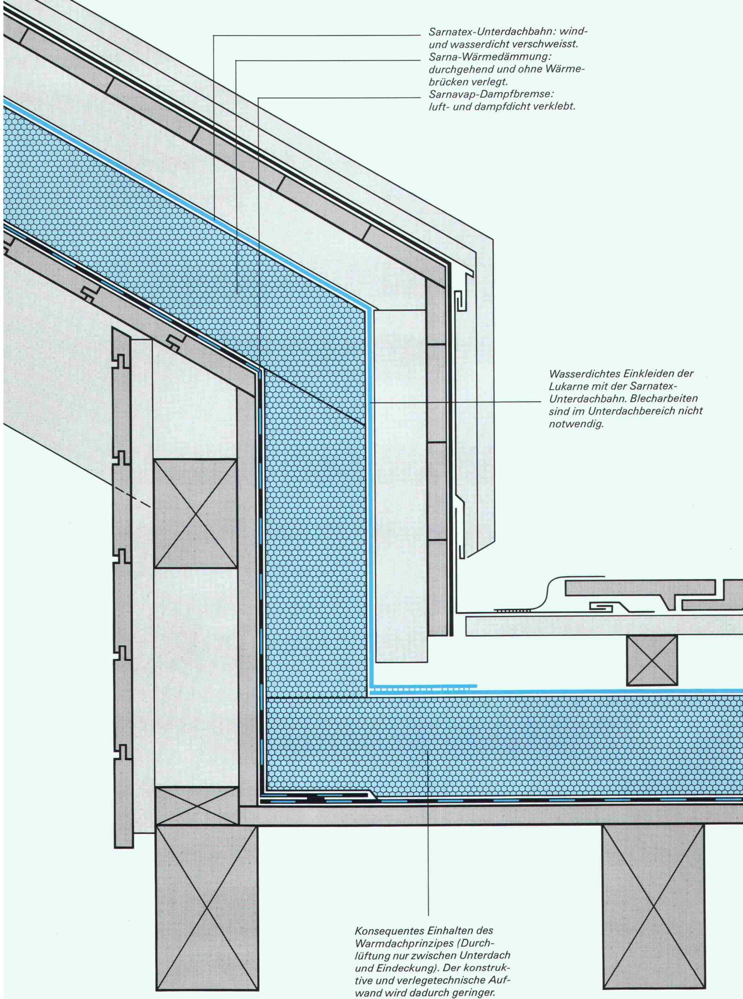
*Sarnatex-Unterdachbahn: wind- und wasserdicht verschweisst.
