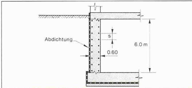
Bild 9. Querschnitt einer Gebäudeuntergeschossmauer
