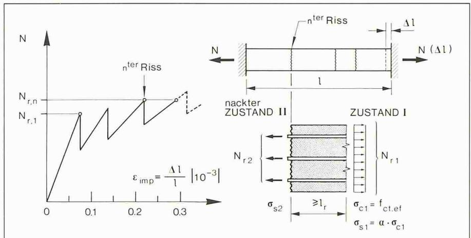
Bild 3. Gleichgewichtsbedingung unter Risschnittkraft im Fall reinen Zuges
