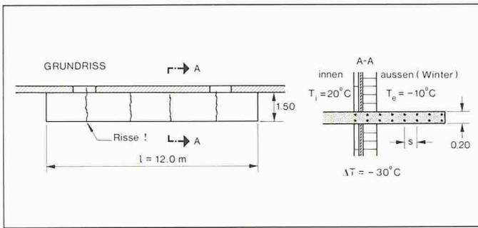
Bild 8. Gefahr von klaffenden Rissen in einer Balkondecke
