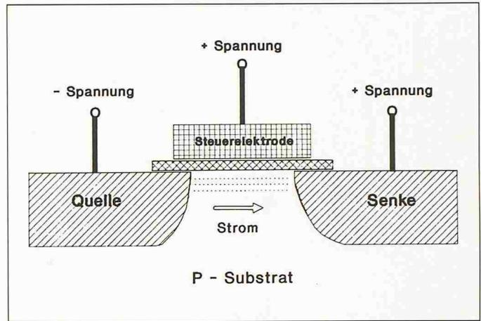
Bild 12. Feldeffekttransistor (FET)-Technologie
