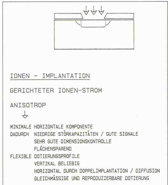
Bild 19. Dotierungs-Technologie: Ionen-Implantation
