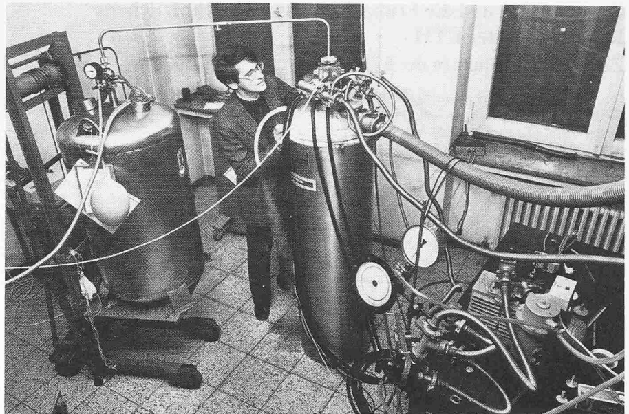
Im physikalischen Institut der Universität Würzburg stand ein Supraleitungsmagnet zur Verfügung, der bei wesentlich kleineren Abmessungen ein Feld von maximal 16,6 Tesla liefert. Im Bild links das Vorratsgefäss mit flüssigem Helium zur Kühlung des Magneten und des MOSFET-Bauelements, in der Mitte der Supraleitungsmagnet und rechts das Pumpsystem zur Abkühlung des MOSFET auf Temperaturen unterhalb des Siedepunkts des Heliums, 4,2 Grad über dem absoluten Nullpunkt
