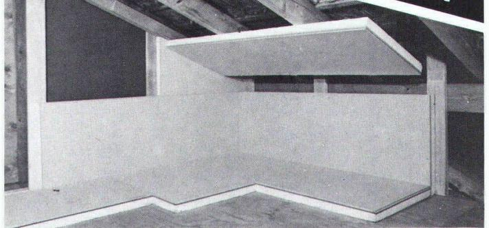
WESPAN-Normisolierelemente sind als Boden-, Wand- und Deckenisolierplatten genormt, allseitig genutet und einseitig mit Polystyrol-F20 oder mit Flumrocplatten beschichtet. Div. Platten- und Isolationsstärken. K-Werte bis 0,32 W/m<sup>2</sup> K. Einsparung von ca. 30–50% Arbeitskosten. Isolieren, sanieren in einem Arbeitsgang. Keine Kältebrücken u. Fugen (Nut- und Federverleimung).
