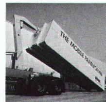
Die BEMO-Profile können mit eingefalzter Gummidichtung ausgerüstet werden. Sie sind in Aluminium, Stahl, Kupfer, Zink und Chromstahl in Baubreiten von 250-600 mm und in Materialdicken von 0,4-1,2 mm lieferbar. Um noch rationeller arbeiten zu können, haben wir die mobile Fabrikation «THE MOBILE PANELFORMER» entwickelt. Mit diesem computergesteuerten Walzwerk fabrizieren wir genau nach Einsatzplan vor Ihrer Haustüre. Dadurch können teure Transportkosten eingespart werden.
