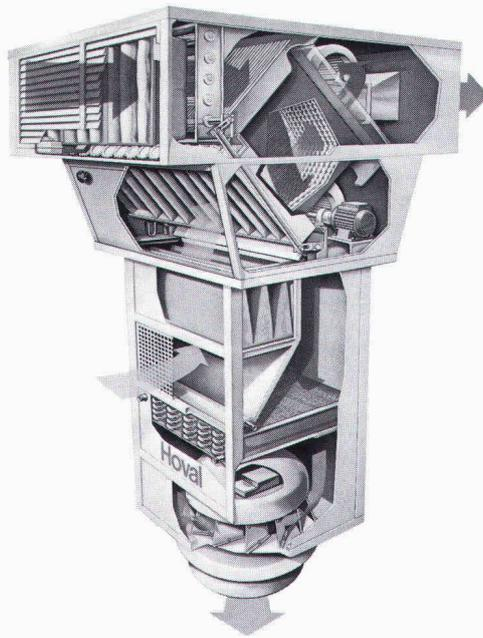
**Hoval HexaFlow.** Rotations-Wärmetauscher für regenerative Wärmerückgewinnung aus Abluft. Dieser äusserst wirtschaftliche Wärmetauscher kommt überall dort zum Einsatz, wo in lufttechnischen Anlagen sowohl ein Wärme- bzw. Kältetausch als auch eine Feuchtigkeitsübertragung gewünscht wird.
