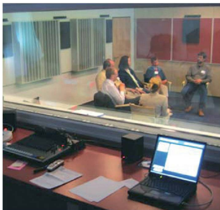
01 Kommunikationsakustik-Simulator und angrenzender Regie- und Kontrollraum. Insgesamt lassen sich derzeit über 90 verschiedene Presets und damit akustische Räume anwählen
