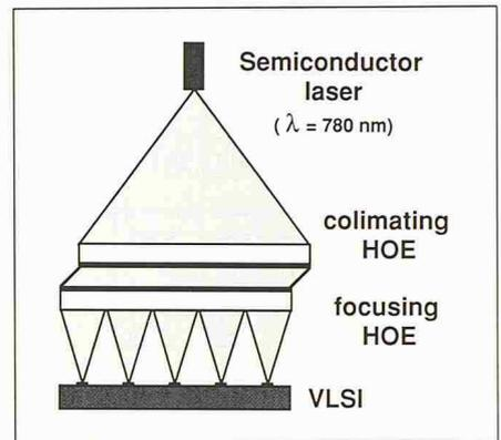
Bild 6. Holographisches System zur Erzeugung einer Rasteranordnung von Laserstrahlen zur Verteilung des Clock-Signals auf einem VLSI-Chip
