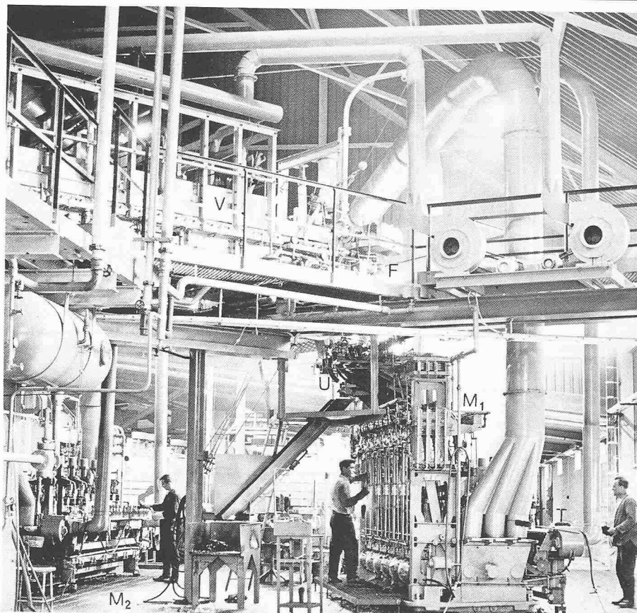
Bild 29 Serienmässige Herstellung von Flaschen, Flaconnage und Weithalsgläsern in von einer zentralen, grossen Schmelzwannen-Anlage mit Vorherden und mittels Tropf-Speisern (Feedern) mit Glasposten versorgten, vollständig selbsttätig arbeitenden Formmaschinen. Blick auf die zu ebener Erde stehenden Blasmasschinen.
