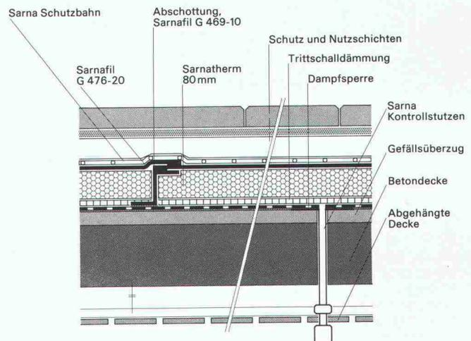
Eine Folge der kontinuierlichen Weiterentwicklung der Sarna-Flachdach-Technologie für gewerbliche Bauten: Die Abschottung mit permanenter Dichtigkeitskontrolle macht die Sicherheit sichtbar.
