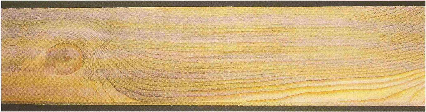
Bild 5. Durch «Bläue» wird das Holz nur in seiner ästhetischen Wirkung verändert
