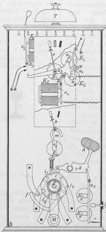
Abb. 8. Vertikalschnitte des Blocksignalapparates. — Masstab 1 : 10.
