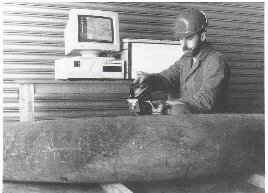
Wärmemikroskop, hier im Einsatz an einer Rohrbiegung im konventionellen Kraftwerksbau. Der Computer macht die Materialeigenschaften sichtbar
