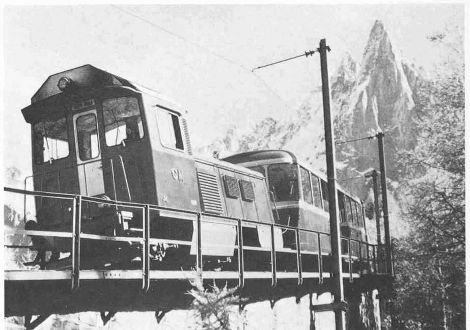
Bild 2. Dieselhydraulische Zahnrad- und Adhäsionslokomotive mit Vorstellwagen der Chamonix-Montenvers-Bahn
