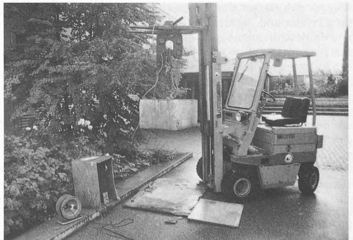
Bild 2. Der an einer Ausklinkvorrichtung hängende Betonquader wurde mit einem Hubstapler auf die notwendige Fallhöhe angehoben
