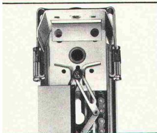
Der seitliche Zwangsantrieb durch Stahlscherenglieder garantiert:
