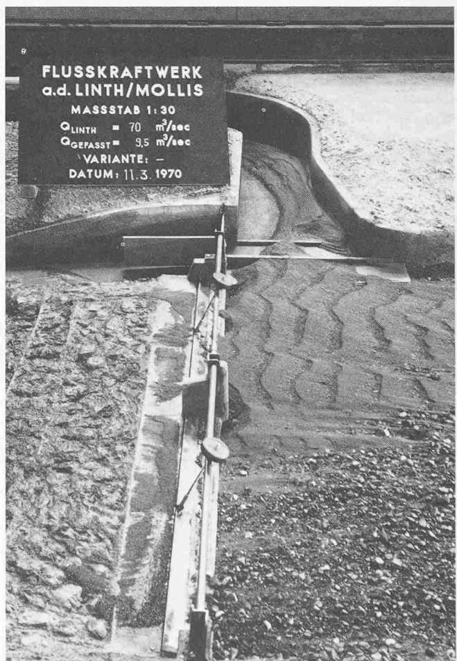
Bild 6. Bei bestehender Fassungsanlage starkes Eindringen von Geschiebe
