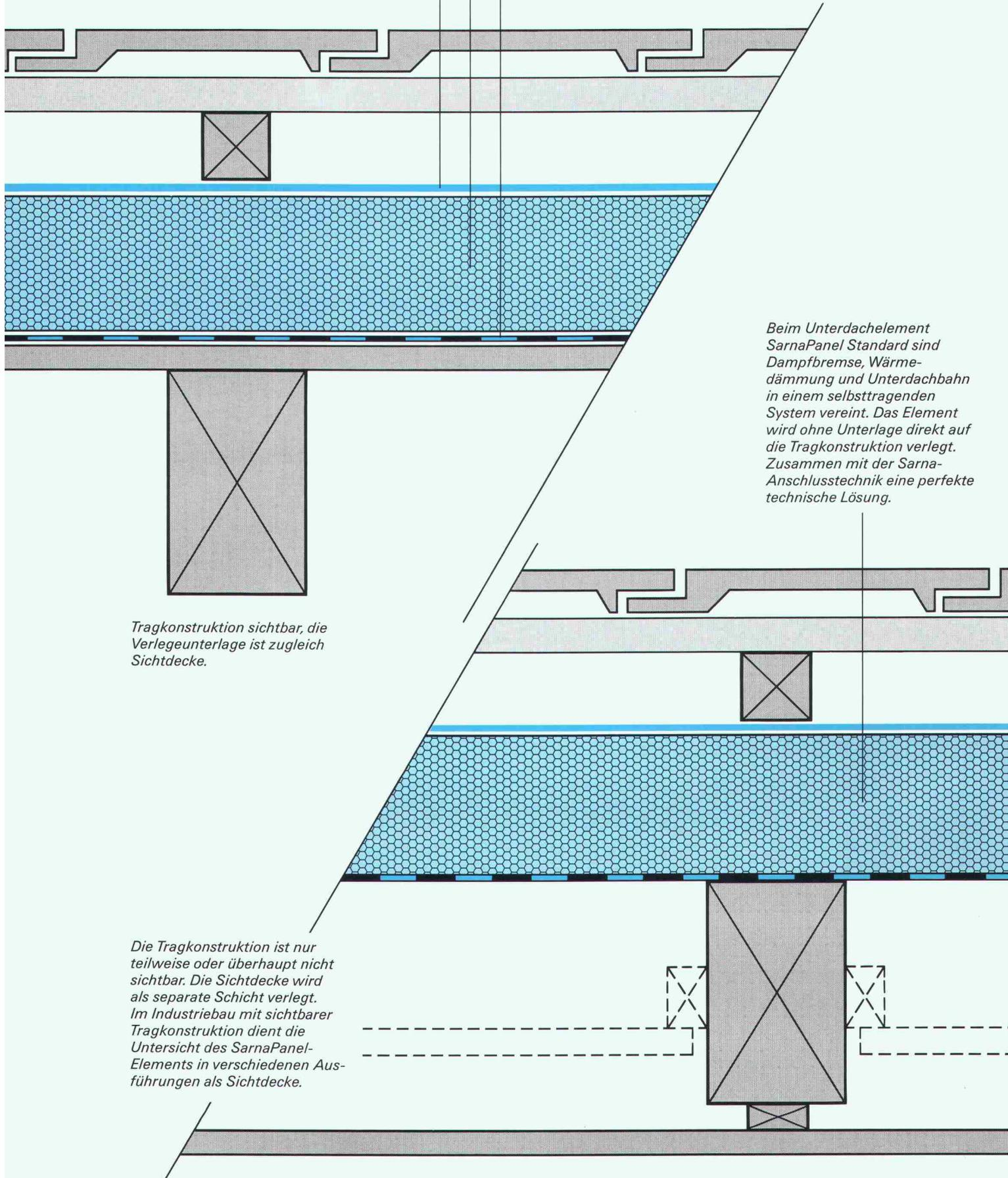
Beim Unterdachelement SarnaPanel Standard sind Dampfbremse, Wärmedämmung und Unterdachbahn in einem selbsttragenden System vereint. Das Element wird ohne Unterlage direkt auf die Tragkonstruktion verlegt. Zusammen mit der Sarna-Anschlusstechnik eine perfekte technische Lösung.
