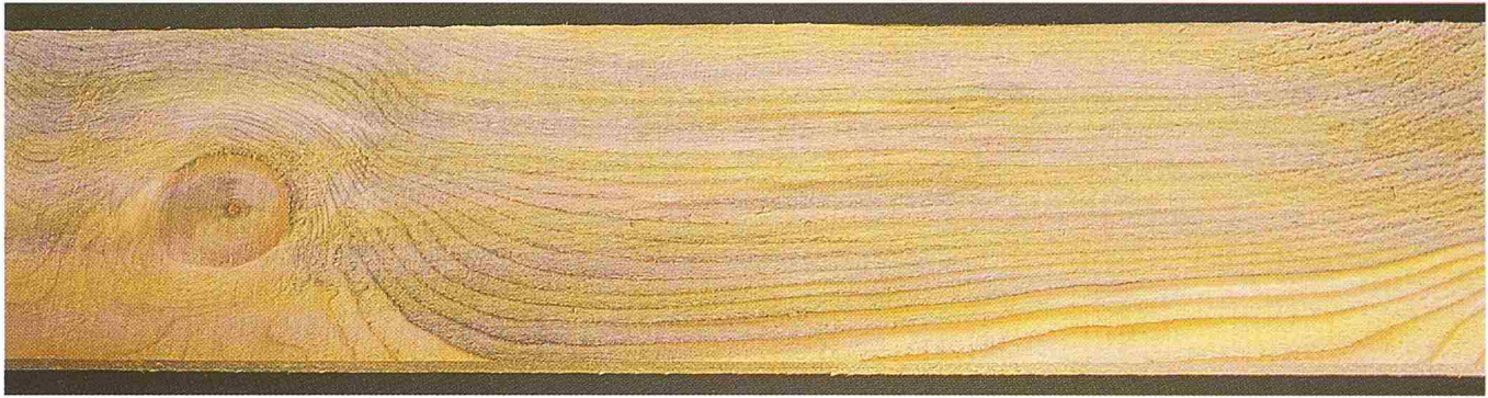
Bild 5. Durch «Bläue» wird das Holz nur in seiner ästhetischen Wirkung verändert
