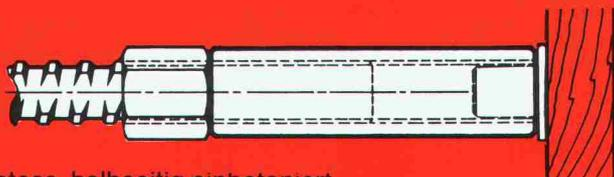
Gewi-Muffenstoss, halbseitig einbetoniert
