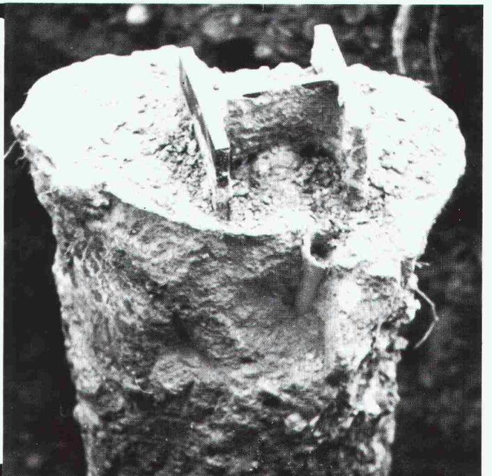
**bhi-Atlas-Rammpfähle** sind runde injizierbare Fertigbetonpfähle mit einem Durchmesser von 450 mm. Sie eignen sich für alle Böden und zeichnen sich durch hohe Belastbarkeit und hohe Biegefestigkeit aus. Ihr runder Querschnitt sorgt für eine starke Mantelreibung und ihre Konizität für eine Steigerung der Tragfähigkeit.
