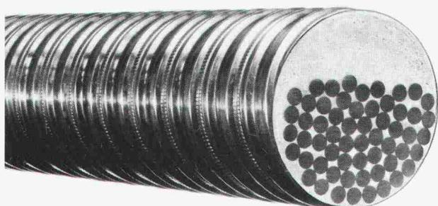
Die für BBRV-Spannkabel angewendete Injektionstechnik bietet Gewähr für die vollständige Verfüllung des Hüllrohres und damit für den bestmöglichen Korrosionsschutz.
