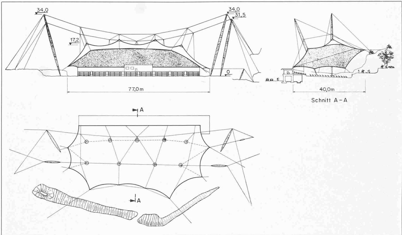
steten Zonen, wie z. B. den Hochpunkten, in den Gratseilbereichen und an den Rändern, verstärkte man die Membran mit ein oder zwei weiteren Materiallagen. Die Zuschnitte
