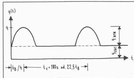
Bild 39. Verlauf des Staudruckes nach *Schlaich* [2]
