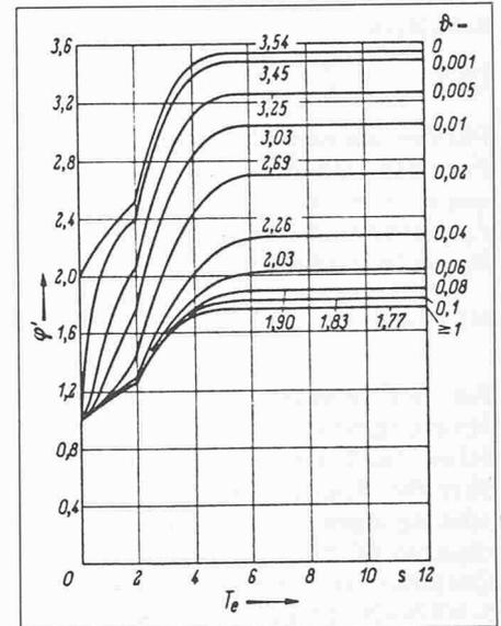
Bild 40. Dynamischer Beiwert  $\phi'$  nach *Schlaich* [2]
