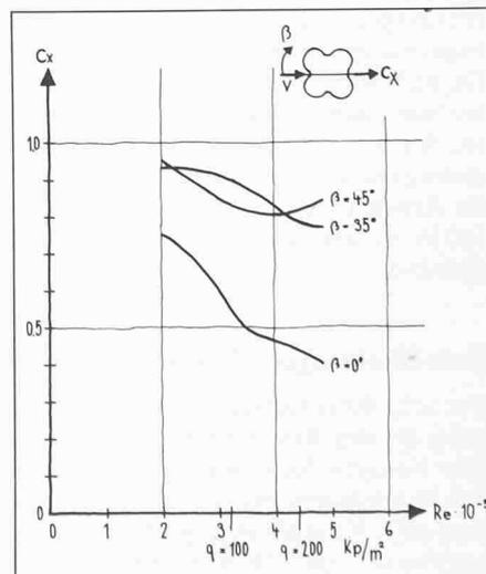
Bild 36. Am Modell im Windkanal gemessene Windwiderstandsbeiwerte  $c_x$
