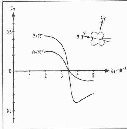
Bild 38. Am Modell im Windkanal gemessene Seitenkraftbeiwerte  $C_y$
