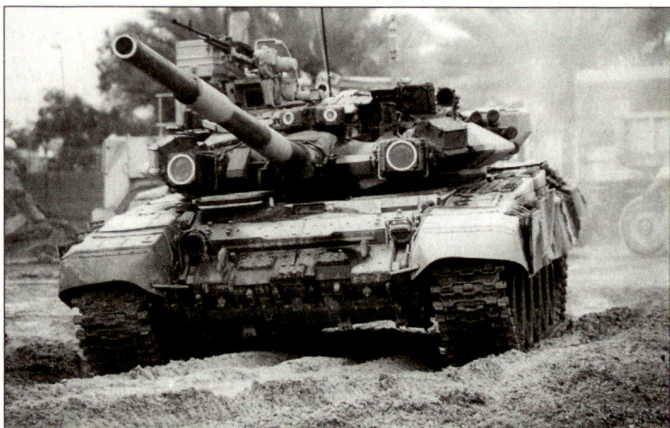
Kampfpanzer T-90S ausgerüstet mit dem aktiven Schutzsystem «Shtora».
