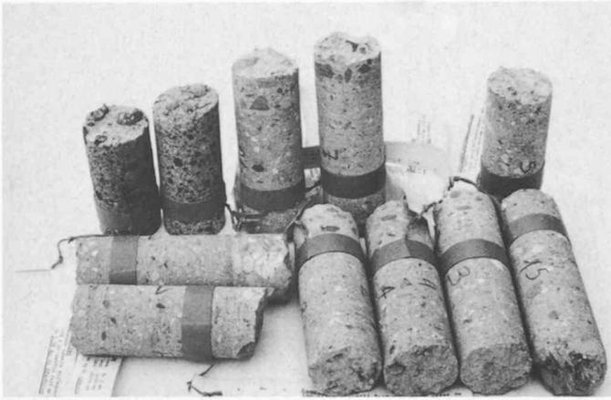
Bild 4. Spritzbeton-Kleinbohrkerne (50 mm Durchmesser)
