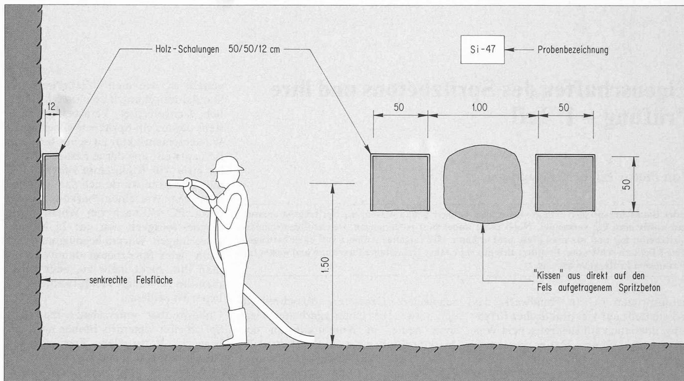
Bild 2. Herstellung von Spritzbetonmustern 50×50×12 cm
