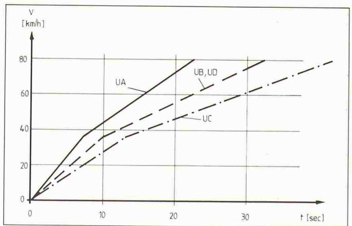
Bild 18. Beschleunigung der verschiedenen Fahrzeug-Konzepte bei identischem Traktionssystem:
