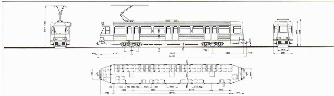
Bild 14. Typenbild des LRV (Light Rail Vehicle)
