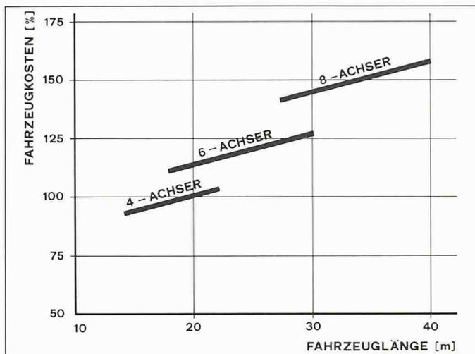
Bild 12. Fahrzeug-Kostenvergleich
