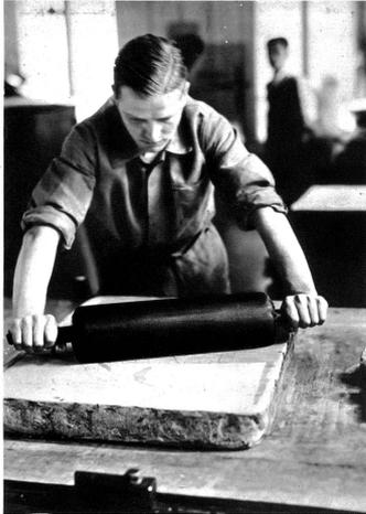
Der Stein wird eingefärbt um Probeabzüge herzustellen
